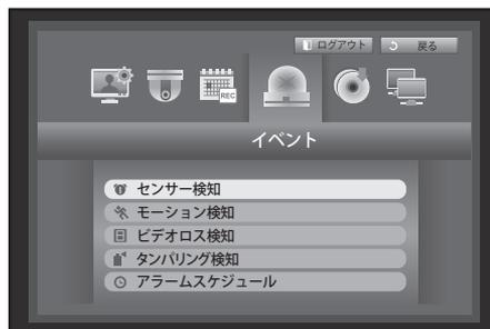
3. 上/下ボタン(▲▼)を使用して<センサー検知>に移動し、[ENTER]ボタンを押します。
