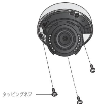
2. 電源とビデオケーブルを接続し、マウントブラケットに本体を取り付けるときに通す穴にビデオケーブルを通します。ケーブルを損傷したりねじらないように注意してください。
