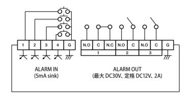
■ レコーダーのGroundシグナル(FG)をAlarm電源(DC)に接続しないでください。
