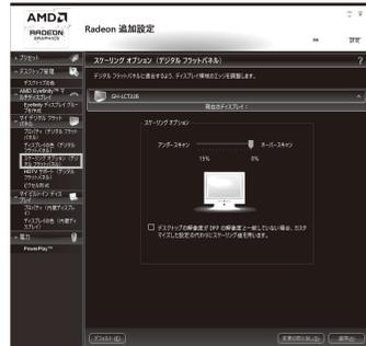
③ 表示された「スケーリングオプション(デジタルフラットパネル)」の「スケーリングオプション」の slider を右側に移動させ、非表示の領域がなくなったら、「適用」をクリックして終了します。
