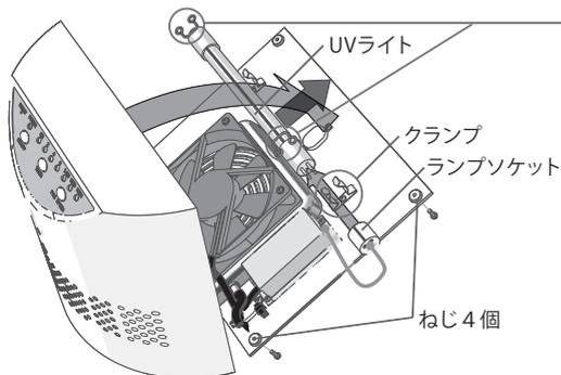
固定ピンを取外します。(下図ご参照)
