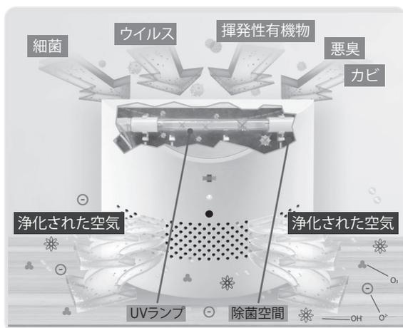
本体に取り込まれた空気は、内部の除菌空間で内蔵のUVランプより照射される紫外線の「酸化作用」と「DNA損傷」「発生したオゾン」により、細菌、ウイルスをDNA・RNAレベルで除菌、揮発性有機物（VOC系）、悪臭、カビ臭を抑制し、浄化された空気になります。
